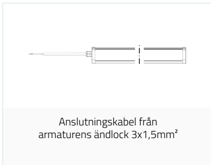
Anslutningskabel från armaturens ändlock 3x1,5mm 2 med Schuko-uttag
